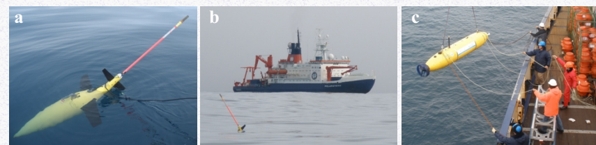
(a) Wodowanie autonomicznego glidera, (b) glider na powierzchni na tle lodolamacza badawczego Polarstern oraz (c) wypuszczanie podwodnego pojazdu z napędem mechanicznym (foto Anna Beszczyńska-Möller).
